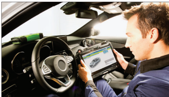
Obr. 1. Systém SDA, Secure Diagnostic Access, umožňuje plný přístup k diagnostickým datům vozidel od zúčastněných výrobců
