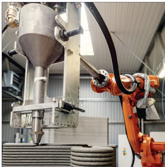
Obr. 1. Tisková hlava nanáší vrstvu betonu (foto: Hero and Outlaw)
