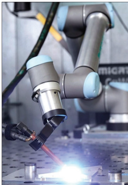
Obr. 2. Svařování obloukem s wolframovou elektrodou v ochranné atmosféře s pomocí kolaborativního robotu (foto: tuliptechs.com)
