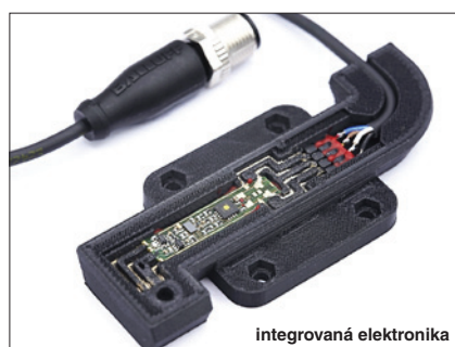
Obr. 2. Demonstrační model snímače vyrobeného 3D tiskem v různých fázích výroby
