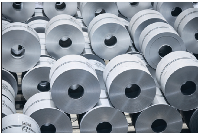
Obr. 1. Svitky, které jsou ošetřovány na kontinuální mořicí lince č. 2, obsahují pás délky až 1,8 km a hmotnosti až 32 t
