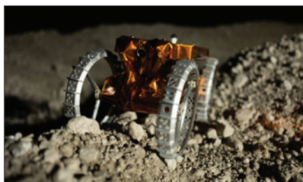
Obr. 2. Bosch společně s firmami Astrobotic, WiBotic a s Washingtonskou univerzitou v rámci projektu Tipping Point NASA vyvíjí techniku inteligentní autonomní navigace pro autonomní roboty CubeRover
