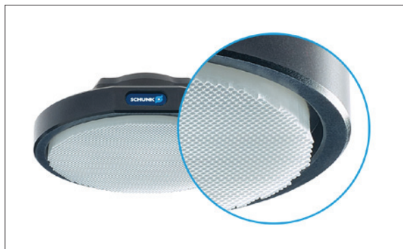
Obr. 3. Chapadlo Adheso využívá k uchopování van der Waalovu sílu; ve videoukázce https://youtu.be/pBTx_1yU5-g jsou příklady použití z farmaceutického průmyslu
