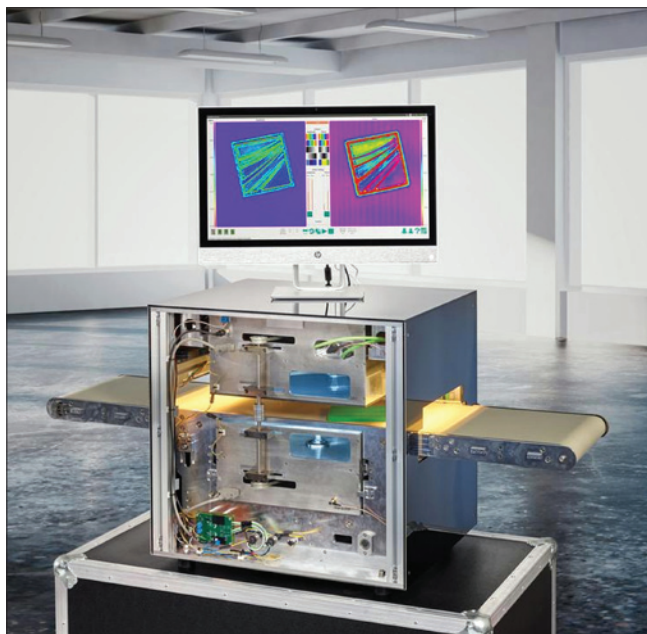
Obr. 3. Skener SAMMI pro sledování kvality plastových výlisků
