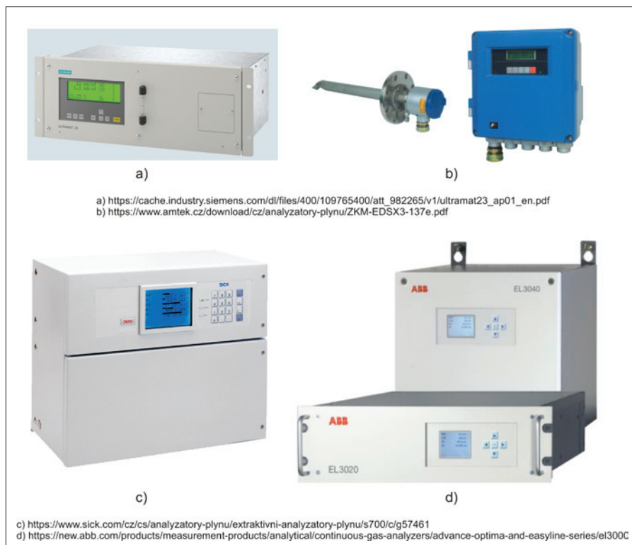
Obr. 2. Příklady stabilních analyzátorů plynů: a) Ultramat 23 (Siemens) – analyzátor IČ-NDIR, UV fotometr, elektrochemický ( H_2S ), ( O_2 ), paramagnetický, b) in-situ Zirconia Oxygen Analyzer (Fuji Electric) – sonda ZFK8, vyhodnocovací jednotka ZKM2, c) analyzátor S700 (Sick) – analyzátor NDIR pro kontinuální měření až tří plynů absorbujících IČ záření, d) EasyLine EL3000 (ABB) – analyzátor: IČ-NDIR, UV fotometr, paramagnetický, tepelně vodivostní, ZrO_2 , FID, elektrochemický
