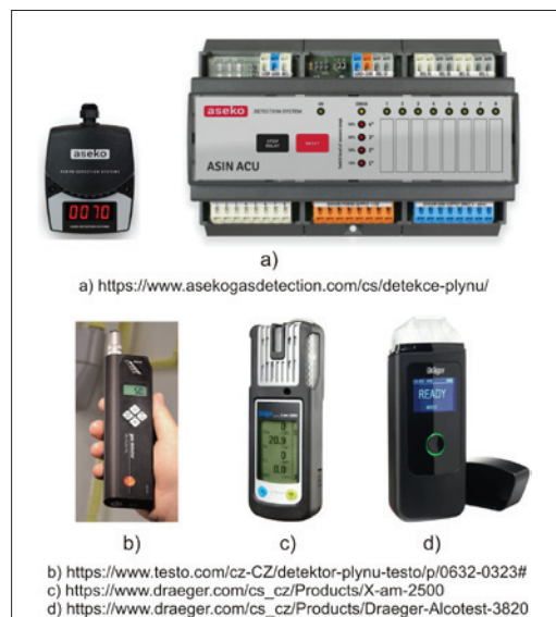
Obr. 3. Příklady detektorů plynů: a) detekční systém ADS (Aseko) – senzory: elektrochemické, infračervené, katalytické, polovodičové, b) Gas Detector (Testo) – detektor plynu pro metan, propan a vodík s polovodičovým senzorem, c) Dräger X-am 2500 – obsahuje elektrochemické senzory, měří hořlavé plyny i páry a také O_2 , CO , H_2S , NO_2 a SO_2 , d) Dräger Alcotest 3820 – analyzátor alkoholu v dechu s elektrochemickým senzorem
