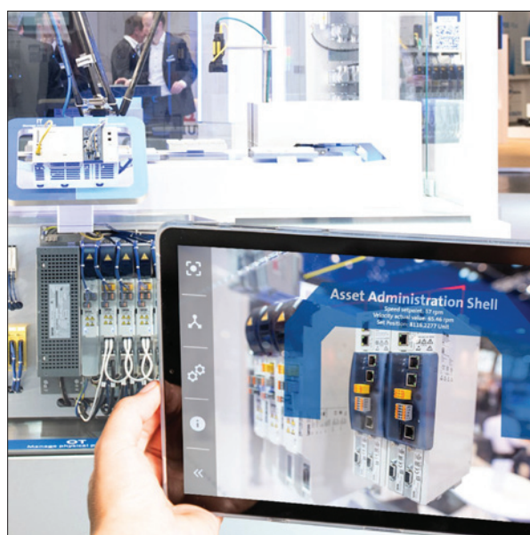
Obr. 2. Měnič i950 je cenným zdrojem dat pro průmyslový internet věcí a aplikace v rámci konceptu Industrie 4.0
