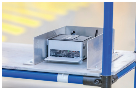
Obr. 2. Airbox v praxi: monitorování materiálu na jednotce MDU
