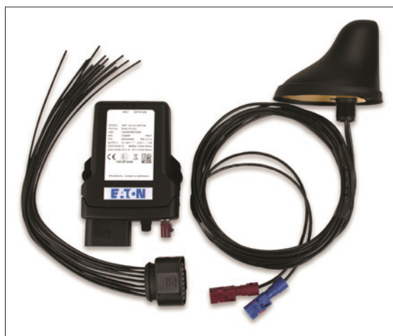
Obr. 4. Komunikační brána TFX je vybavena kromě interní antény i externí anténou pro případ, že je namontována tam, kde není mobilní signál – např. v kabině vozidla
