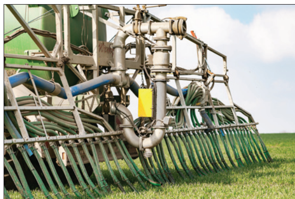
Obr. 2. Dodatečná montáž snímače obsahu dusíkatých látek a průtokoměru na cisternu pro hnojení travních porostů
