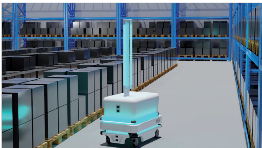
Obr. 1. Dezinfekční robot se rtuťovými germicidními výbojkami na platformě MiR100
