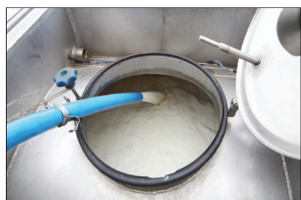
Obr. 4. Při měření průtoku mléka je třeba pamatovat na to, že v něm jsou obsaženy bublinky vzduchu – Promass Q je pro toto měření vhodným řešením
