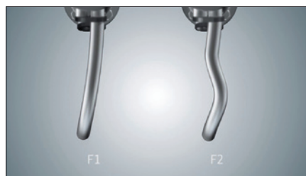
Obr. 2. Metoda MFT pracuje na principu buzení dvou stejných trubic různými frekvencemi kmitů a analýzy jejich chování – bližší viz https://youtu.be/LadsM-PweeU
