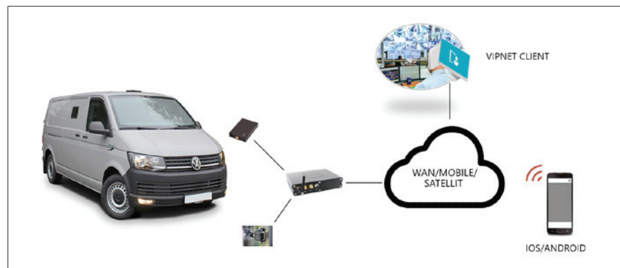
Obr. 1. Softwarově definovaná síť Vipnet zajišťuje přístup k vozidlům prostřednictvím sítí mobilních operátorů
