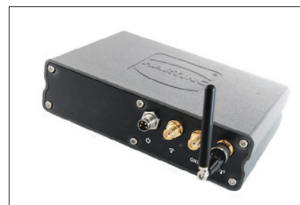
Obr. 2. Základem pro rádiové spojení s vozidlem převážejícím peníze je průmyslový počítač MICA s modulem LTE/WLAN a kartou eSIM
