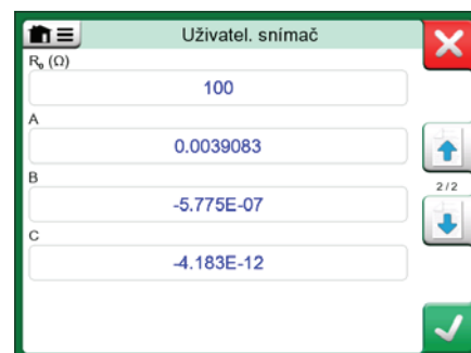
Obr. 2. Korekce snímače podle CvD rovnice na obrazovce kalibrátoru MC6
