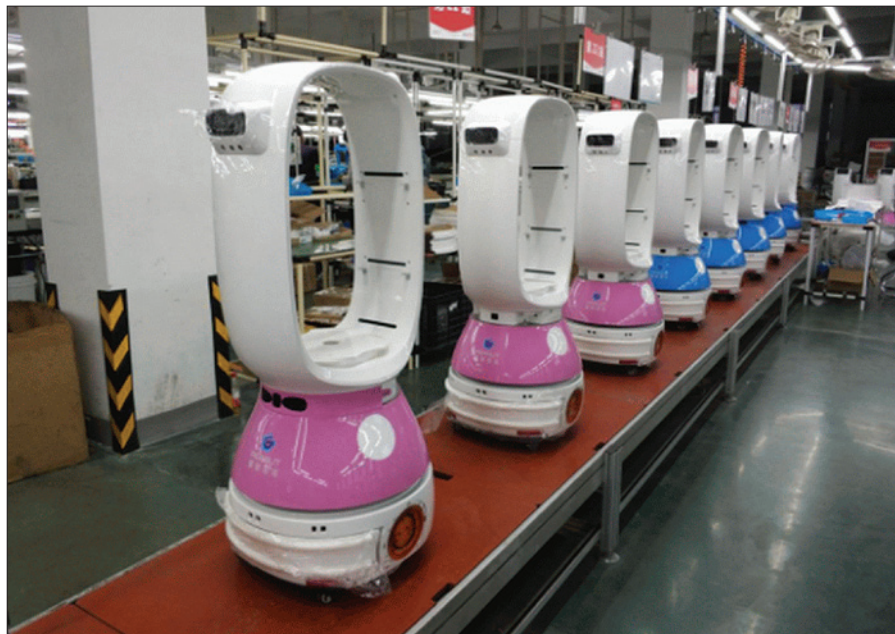
Obr. 2. Výrobní linka restauračních robotů Keenon
