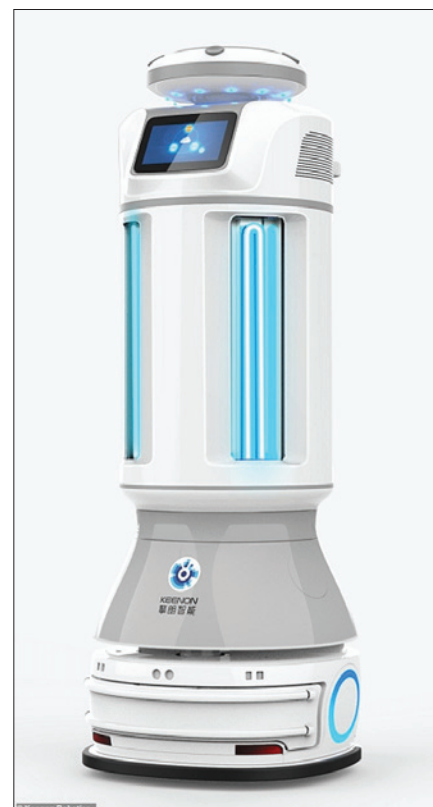
Obr. 3. Dezinfekční robot Keenon kombinuje dezinfekční sprej a UV záření
