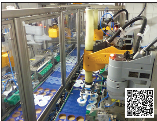
Obr. 1. O skládání kelímků do plat se starají celkem čtyři roboty SCARA Stäubli TS60 (viz také https://youtu.be/pxZjuEw5DF4 , 2:20 až 3:40)
