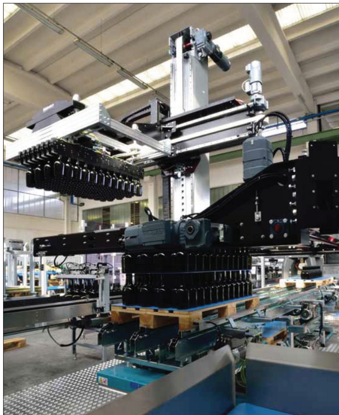
Obr. 1. Manipulační stroj od firmy Zecchetti pro paletizaci skleněných lahví (foto: Zecchetti; představení firmy: https://www.youtube.com/watch?v=kGPIItIVXts )
