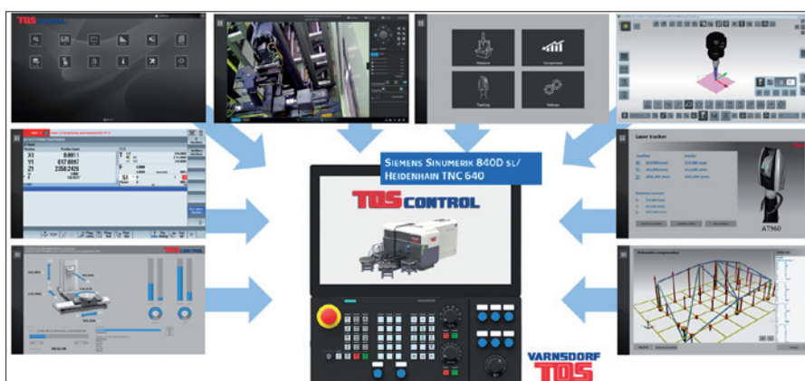
Obr. 2. Významný český výrobce obráběcích strojů TOS Varnsdorf představil programové řešení TOS Control, které propojuje stroj s nadřazenými podnikovými strukturami a vytváří tak platformu pro kompletně digitalizovanou výrobu; metrologický program TouchDMIS je integrován přímo do řídicího systému a umožňuje změřit dílec a následně automaticky zavést potřebné kompenzace (TOS Varnsdorf)
