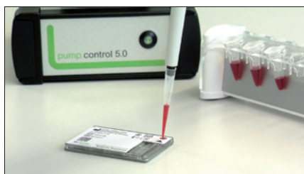
Obr. 1. Mikrofluidní kazeta pro rychlou analýzu bakterií
