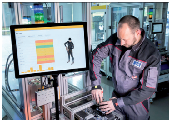
Obr. 1. Sledování pohybů těla pracovníka při použití pracovního obleku s vestavěnými snímači (foto: DFKI)
