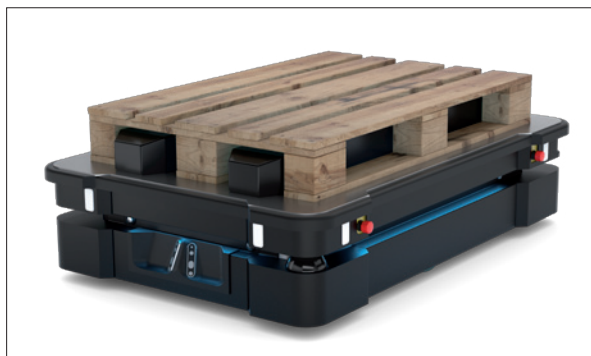
Obr. 2. Automaticky naváděné vozidlo MiR1000 dokáže uvést paletu s nákladem o celkové hmotnosti až 1000 kg (foto: Mobile Industrial Robots)
