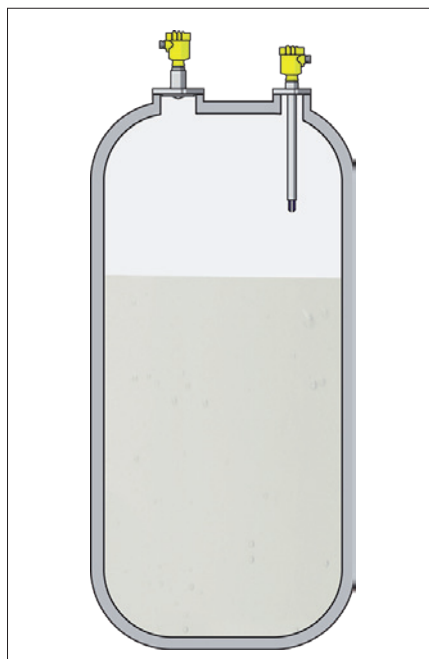
Obr. 6. Měření zaplnění tanku s vápenným mlékem radarovým hladinoměrem s ochrannou před přetečením vibračním spínačem
