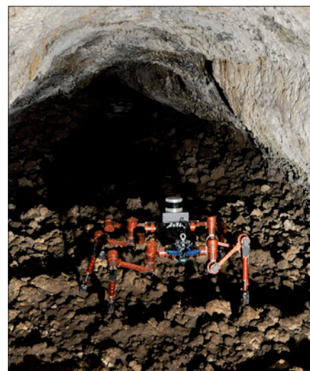
Obr. 3. Šestinohý kráčející robot Crex autonomně zkoumá vnitřek lávové jeskyně na ostrově Tenerife (foto: DFKI GmbH)
