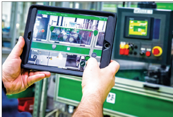
Obr. 2. Ukázka vizualizace na ovládacím panelu s využitím rozšířené reality
