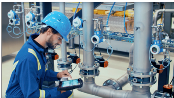
Obr. 1. Endress+Hauser je jedním z prvních výrobců, který umožňuje vybavit své snímače modulem pro mobilní sítě; nová komunikační brána dovoluje v sítích 5G přenášet data z protokolu HART
