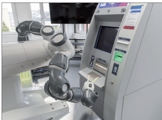
Obr. 1. Dvouruký robot YuMi testuje všechny funkce bankomatů
