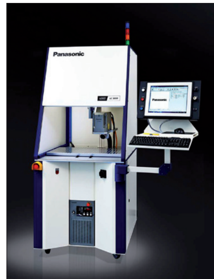
Obr. 6. Pracovní stanice LC 3000 pro manuální svařování jednotlivých dílů nebo malosériovou výrobu
