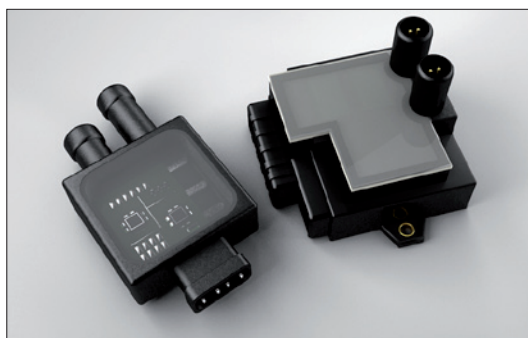
Obr. 2. Do výlisku se před svařováním připevňuje deska elektroniky, konektory, průchodky a další potřebné díly
