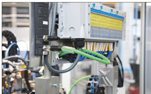
Obr. 1. Konstrukteři mohou jednotlivá zásuvná místa používat jako vstupy nebo výstupy, a mohou tedy z standardních modulů vytvořit „na míru šité“ kombinované moduly
