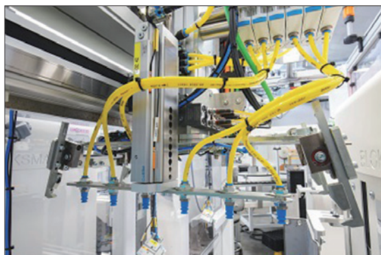
Obr. 4. Pomocí přípojek ventilových ostrůvků Cube67 (vícepólové konektory) je možné ovládat ventily snadno přímo na místě
