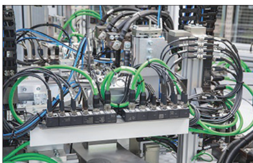
Obr. 2. Systémové vedení, které přenáší data i energii, představuje velkou výhodu ve vlečných řetězcích, kde je často velmi málo místa
