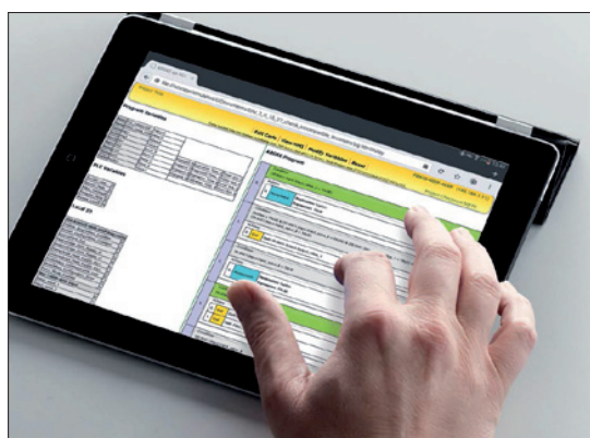
Obr. 4. Programovací prostředí Argee, založené na jazycích HTML5 a JavaScript, umožňuje z multiprotokolových I/O jednotek vytvořit nezávislé decentralizované řídicí moduly
