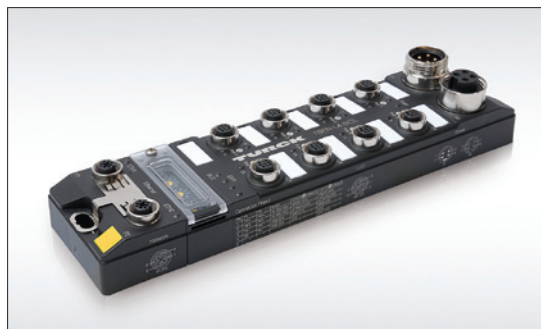
Obr. 3. Modul TBEN-L-8IOL s osmi rozhraními IO-Link master a multiprotokolovým rozhraním pro Modbus TCP, EtherNet/IP nebo Profinet
