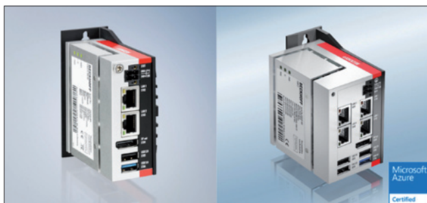
Obr. 1. Kompaktné priemyselné IPC C6015 (vpravo) a IPC novej generácie C6017 (vľavo)
