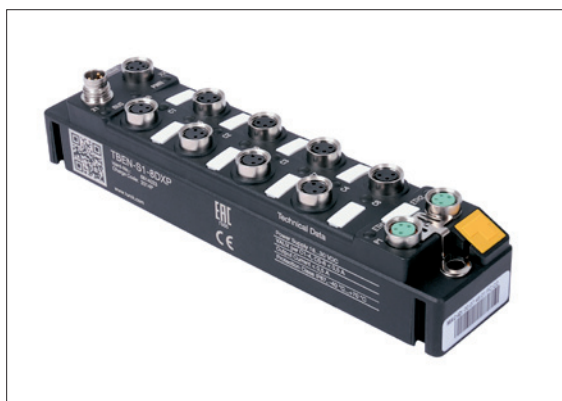
Obr. 1. I/O modul TBEN-S s integrovaným webovým serverem AGREE
