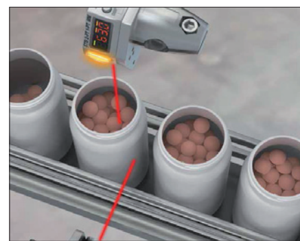
Obr. 4. Laserový snímač Banner Q4X měří zaplnění lahviček s dražé v potravinářské výrobě (video viz http://bit.ly/2UJFOCO )
