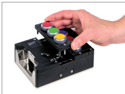
Obr. 5. Vyměnitelné submoduly s ovládacími prvky
