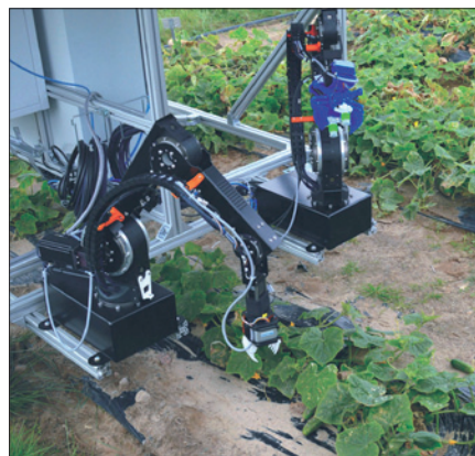
Obr. 2. Prototyp dvouramenného robotického systému během prvního provozního testu (foto: Fraunhofer IPK)
