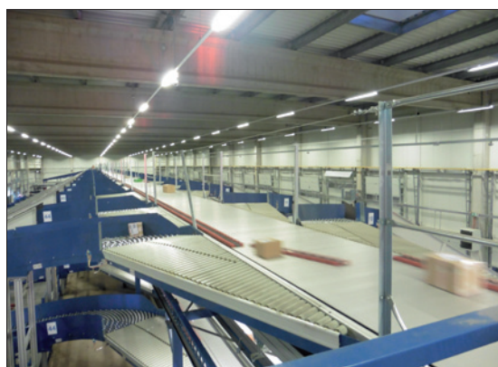
Obr. 2. Botičkový sorter třídí balíky na dopravníky podle dopravních směrů
