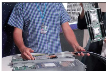
Obr. 2. Chlazení desek plošných spojů vodou
