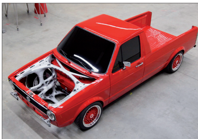
Obr. 1. U automobilu VW Caddy I Youngtimer dokáže 3D tisk vytvořit odlehčenou, ale mimořádně pevnou strukturu přední části vozu ze slitiny Scalmalloy (foto: csi)
