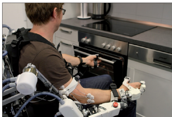
Obr. 2. V jednom z pracovních módů nový exoskelet odvozuje pohyb paže požadovaný pacientem z naměřených elektromyografických signálů (EMG) (foto: DFKI – Annemarie Popp)
