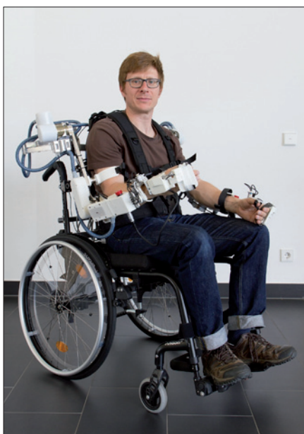
Obr. 1. Mobilní exoskelet pomáhá pacientům po mozkové příhodě opět pohybovat rukama (foto: DFKI – Annemarie Popp)
