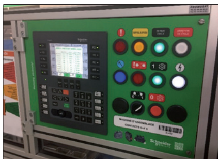
Obr. 3. Tlačítka Harmony XB5F je možné použít i pro retrofit starších panelů
