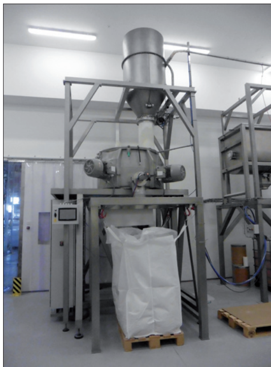
Obr. 2. Zařízení pro vysokorychlostní míchání zastudena
