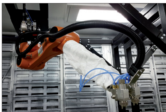
Obr. 2. Robotické lakování je rychlé a velmi přesné
