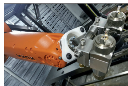
Obr. 3. Automatická stříkácí pistole na konci ramena robotu
