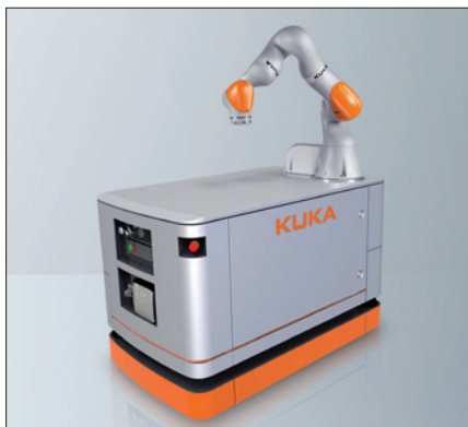
Obr. 2. Mobilní autonomní kolaborativní robot KMR iiwa
