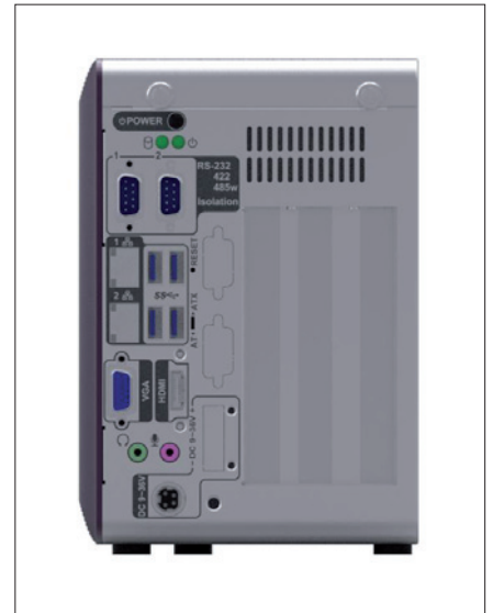
Obr. 2. Detailní pohled na rozhraní počítače TANK-870e-H110
