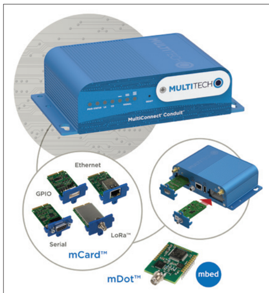
Obr. 1. Internet věcí s použitím komponent MultiTech Systems: komunikační modul mDot (dole) a komunikační brána MultiConnect Conduit s kartami mCard
