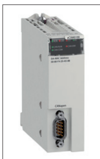
Obr. 1. Nová komunikační brána pro CANopen – modul BMECXM0100 – je odpovědí na požadavky automobilového průmyslu
