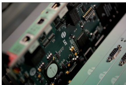
Obr. 1. Řídicí systém SandRA Z210 je vhodný pro řízení výměňkových stanic, malé vodní elektrárny, monitorování a řízení produktvodů, regulační a předávací stanice v plynárenství, zásobníky plynu, čističky odpadních vod a další provozy
