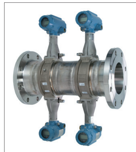
Obr. 6. Rosemount Quad 8800 Vortex SIL 2/3: vírový průtokoměr se čtyřmi nezávislými snímači a převodníky pro redundantní SIS 2oo3
