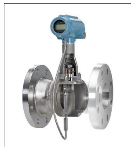
Obr. 5. Unikátní celosvařená konstrukce vírových průtokoměrů Rosemount 8800 s piezosenzorem odděleným od měřeného média pro rychlou výměnu bez přerušování procesu
