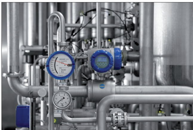
Obr. 5. Plováčkový průtokoměr H250 Food s ukazatelem M40 při výrobě ovocných nápojů
