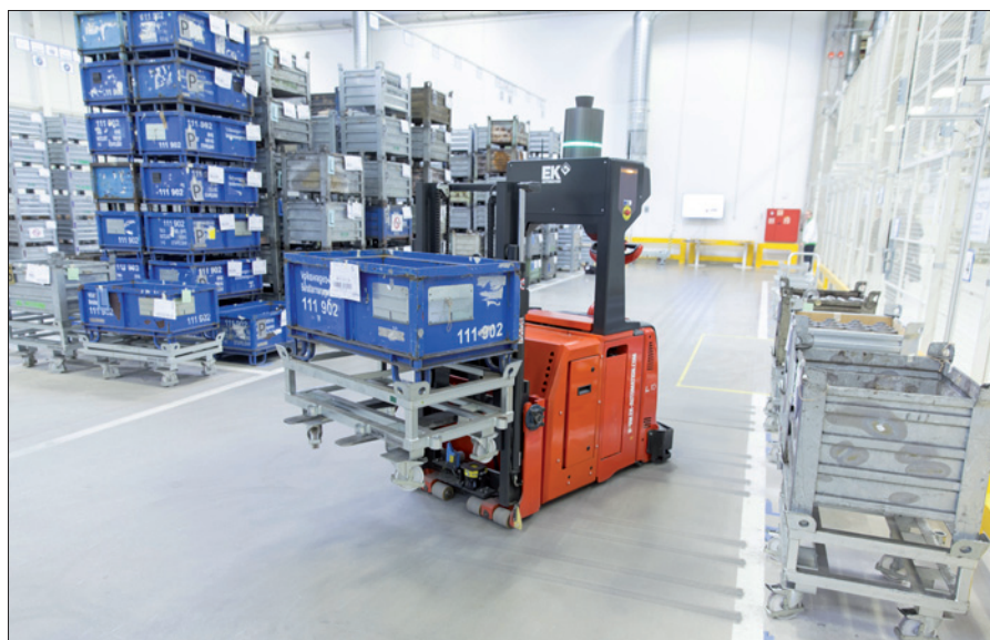
Obr. 5. Autonómni, laserem naváděný vysokozdvíhací vozík dopravuje díly ze skladu na montážní linku
