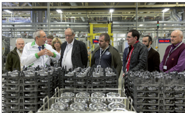
Obr. 1. Polotovary ozubených kol a hřídelí jsou mezi obráběcími stroji převáženy na paletách
